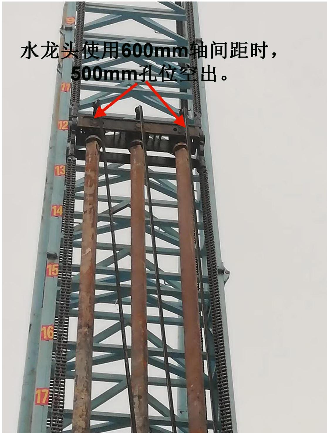
上图为定位 600mm 轴间距的三轴桩机立架中上部，可见水龙头大方框上靠两边水龙头内侧分别有孔位（即，500mm 轴间距孔位空出）。
