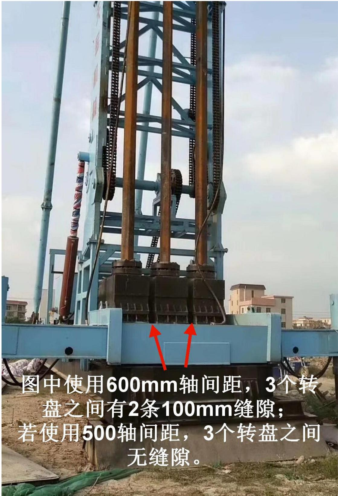
上图为定位 600mm 轴间距的三轴桩机下部，可见 3 个转盘中间有 2 条缝隙（即，500mm 轴间距孔位空出）。
