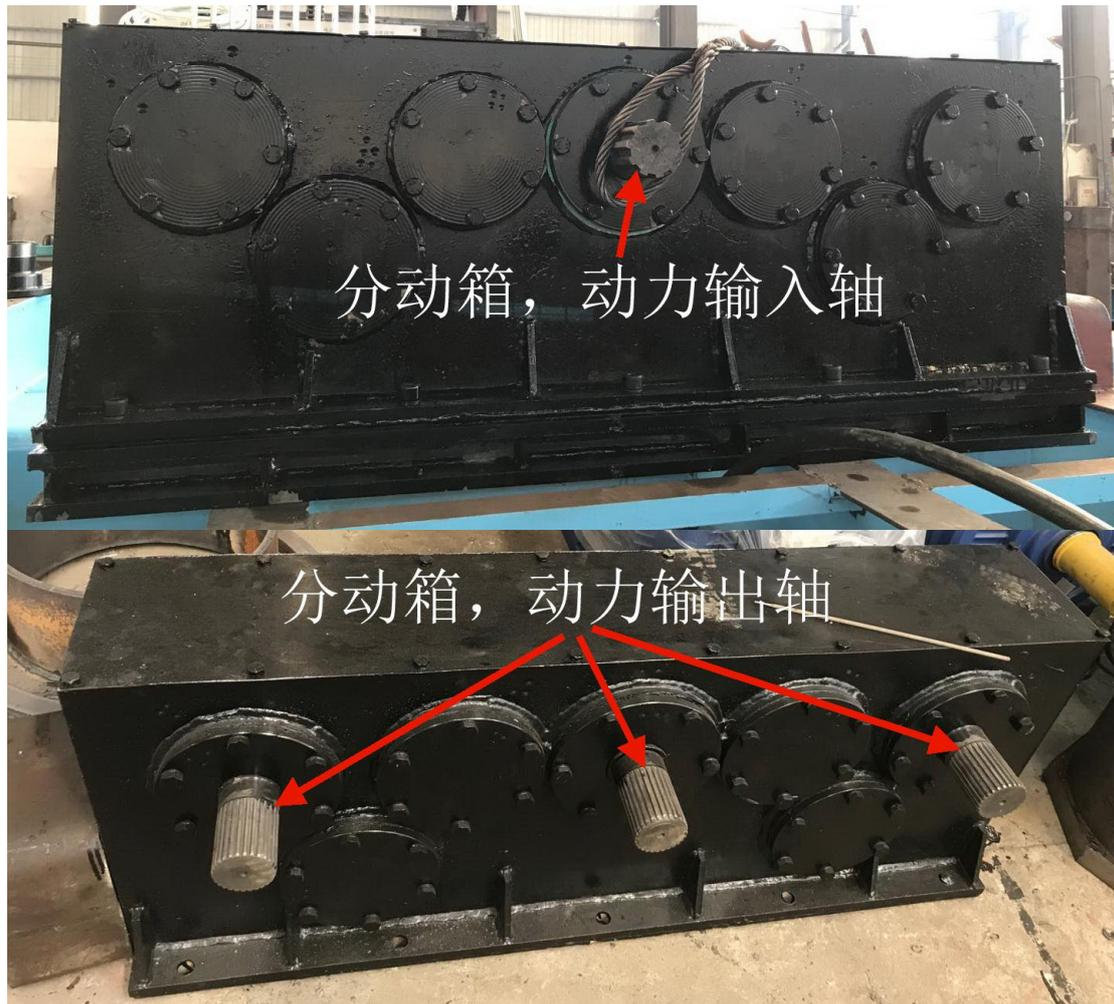
图中黑色箱体为分动箱。分动箱将来源于一个电机的动力一分为三，分别输出到三个转盘。通过更换不同输出轴距（通常为 500mm 和 600mm）的分动箱来对应以不同轴间距布局的转盘。如，输出轴距为 500mm 的分动箱对应以 500mm 轴间距分布的转盘；输出轴距为 600mm 分动箱对应以 600mm 轴间距分布的转盘。
